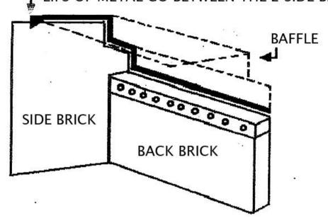
WHEN PUTTING THE BAFFLE INTO THE STOVE TAKE THE CASTLE OUT. THE REMOVE THE RIGHT HAND SIDE BRICK
